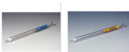
**FRE-103820 e FRE-103840** – Dinamometri di precisione da 1 e 5N di portata. Precisi, con doppio gancio, hanno scala incisa, zero regolabile, e la costruzione chiusa impedisce di stirare la molla interna.
