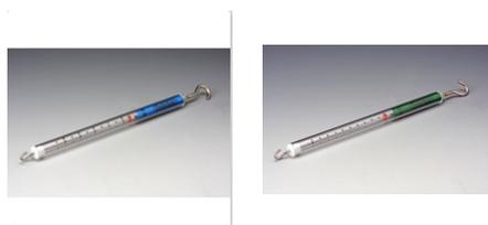
**FRE-103840 e FRE-103850** - Dinamometri di precisione da 5 e 10N di portata, per introduzione alle forze e ai vettori. Utilizzabili poi anche con il sensore di forza dei carrelli. Precisi, con doppio gancio, hanno scala incisa, zero regolabile, e la costruzione chiusa impedisce di stirare la molla interna.
