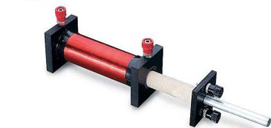
**SE-8653** – un kit di solenoidi ben progettato, con due bobine concentriche con diverso numero di spire ed un nucleo rimovibile. Abbastanza grande (l'esterno è circa 120 mm per 20 di diametro) da permettere un campo magnetico omogeneo al suo interno, o di farci cadere attraverso un magnete. La grande sensibilità dei sensori permette di usare tensioni e correnti modeste nelle dimostrazioni.
