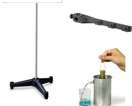
**ME-9355, ME-9506 e SE-8568** – Base con asta, attacco speciale per molle e pendoli e vasetto con beccuccio. Permettono di montare le esperienze di Hooke e di Archimede in maniera ripetibile e precisa, e di realizzare ogni misura di elongazione delle molle con una semplice riga, o di misurare la densità anche di corpi con forma irregolare., come quelli forniti in ME-8569A (incluso nel pacchetto).
