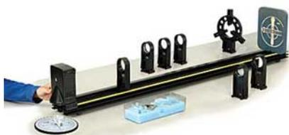
**OS-8515C** – Banco ottico completo. Include una sorgente di luce multifunzione, che fornisce fonte puntiforme, fonte estesa, 1, 3 o 5 raggi per l'ottica piana, bande colorate; kit ottica piana; quattro lenti assortite; schermo di proiezione; specchio convergente e relativa semilamina rotante per osservare l'immagine; goniometro e lente a "D". La particolare forma del banco e dei supporti permette allineamenti istantanei e perfetti dei vari componenti.
