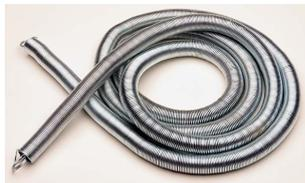
**SE-7331** – La classica molla "snakey" da utilizzare sul pavimento o un lungo banco (quando tesa arriva a 10 metri!). permette di evidenziare, ovviamente in maniera qualitativa, l'esistenza delle onde longitudinali e trasversali, le onde stazionarie, la sovrapposizione delle onde.
