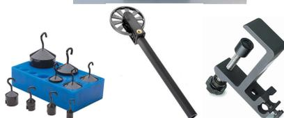
**ME-9355, ME-9376B, ME-9499, ME-8744, ME-8736 SE-8759** – Tutto il necessario per sistemare la corda vibrante e sottoporla a tensione, in modo da poter controllare tutti i parametri in gioco. Sono incluse una base pesante con asta, un morsetto da tavolo con asta, puleggia a basso attrito su astina, attacco a snodo, set di masse (alcuni prodotti non sono illustrati, ma è incluso tutto il necessario).
