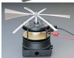
**SF-9404** – "Strisce risonanti". Semplicissimo accessorio dell'oscillatore (qui illustrato montato sull'oscillatore stesso). Delle strisce metalliche, entrano in risonanza a frequenze diverse, in base alla loro lunghezza.
