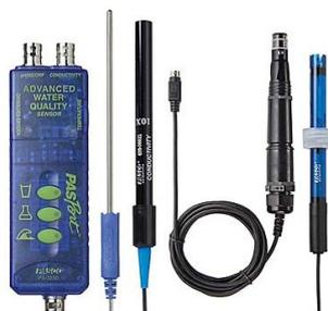
**PS-2230** – Sensore avanzato per la qualità dell'acqua. Misura pH, conducibilità elettrica, temperatura, ossigeno disciolto (con sensore ottico) e pressione barometrica (direttamente dal corpo del sensore). Utilizzabile ovviamente anche per molte esperienze di chimica. Il sensore di ossigeno disciolto, basandosi su un principio ottico, NON si consuma ed è molto più preciso ed affidabile di tecnologie alternative.
