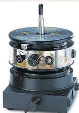
**SF-9324** – Oscillatore elettromeccanico per la corda vibrante e le strisce risonanti, espandibile eventualmente con le lastre di Chladni ed altri accessori. Estremamente robusto, assicura anni di utilizzo. Risposta molto lineare nel campo 1...300Hz circa, utilizzabile sino a qualche centinaio di Hz. Include la corda adatta all'esperimento della corda vibrante.
